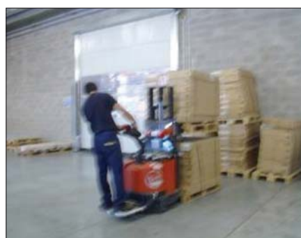
Figura 4. Transpallet elettrico in funzione
